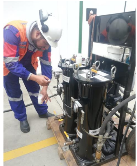
Toma de muestra utilizando el puerto de muestreo instalado en el equipo de filtración, una sonda especial de recolección y un envase especial diseñado para esta actividad para su envío al laboratorio
